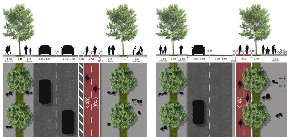
Figura 16. Perfis-tipo de canais próprios – pista e corredor
