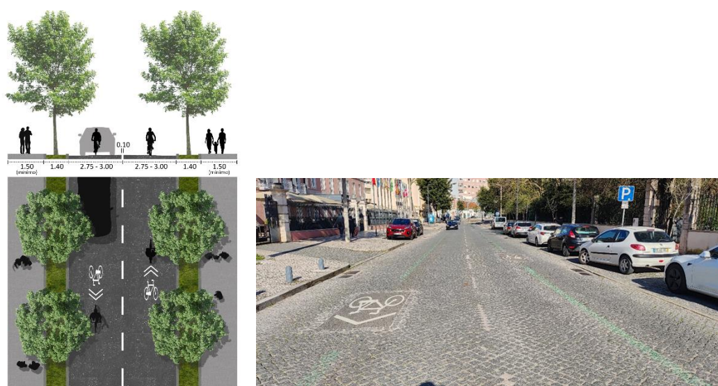
Figura 18. Perfil-tipo de canal partilhado com o automóvel e imagem de referência
